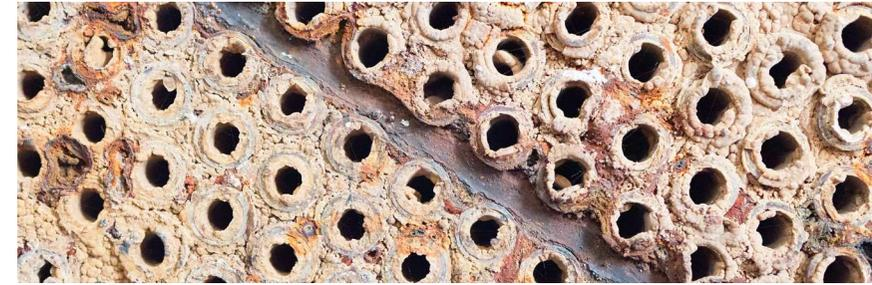
Ausfällungen von Kalziumkarbonatsalzen und Korrosion auf Wärmeübertragungsoberflächen vom Röhrenwärmetauscher.
