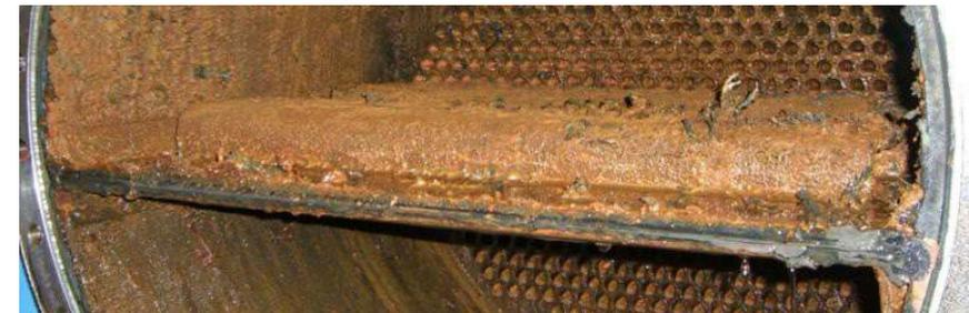
Ablagerung und Ansammlung vom Schlamm im Inneren des Wärmetauschers erhöht seinen Energieverbrauch und verringert seine Leistung.
