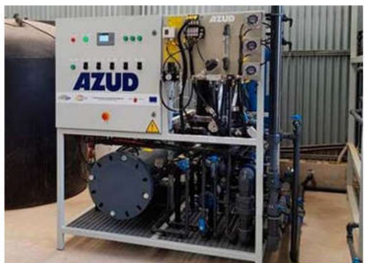
Testanlage zur Untersuchung der Rückgewinnung von aufbereitetem Abwasser
